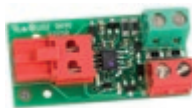
Interfaz BUS XIB (para tarjeta E045 o E045S o E024S con fotocélula no BUS)
