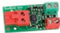
Interfaz BUS XIB (para tarjeta E045S o E045S o E024S con fotocélula no BUS)
