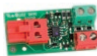
Interfaz BUS XIB (para tarjeta E045 o E045S o E024S con fotocélula no BUS)
